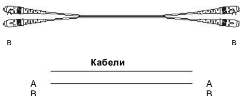
Соединительные кабели ST-портов
